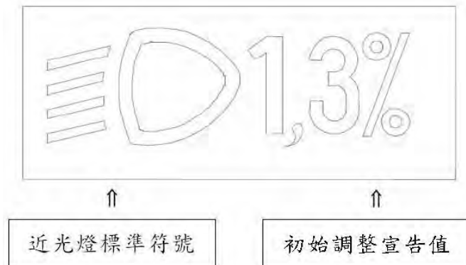
圖六之一：近光燈初始調整值及符號範例
