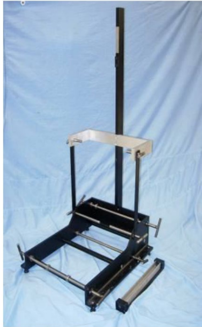
圖 14：HPM/HRMD 校正治具（GLORIA）
