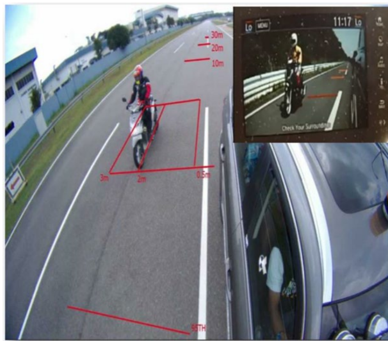
圖 18：盲點視覺系統之試驗之影像記錄器畫面
