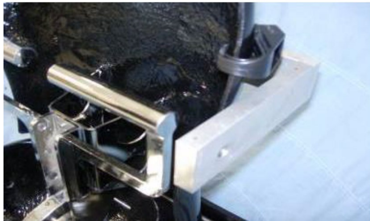
圖 17：以支撐帶固定 HPM 背板
