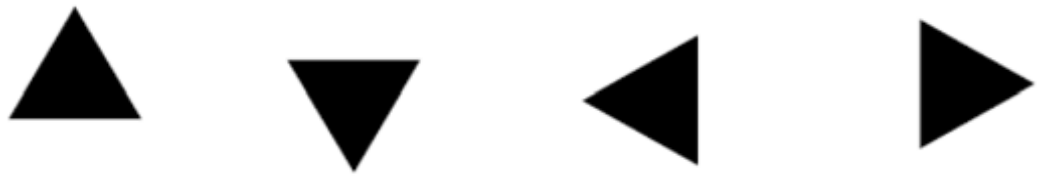
圖九：三角方位識別(TOD)測試圖形
