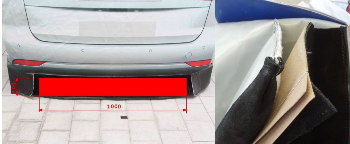
圖 16：左側圖片為目標車之前視圖，包括下側雷達吸收墊之位置；右側圖片為不同層之吸收墊
