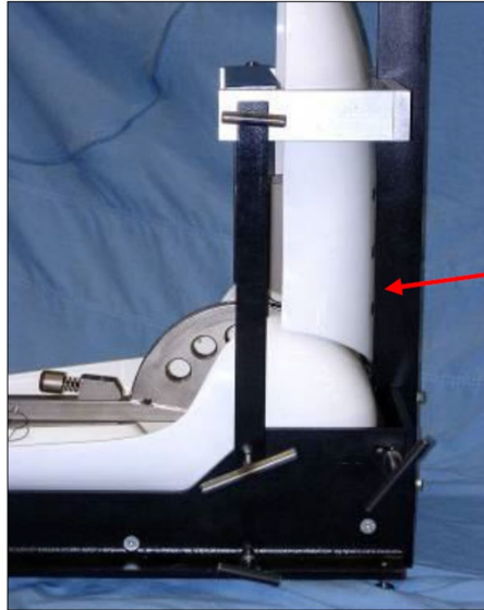
圖 19：HPM（未裝配 HRMD）安裝於治具。應檢查以確保 HPM 背板與治具垂直支撐桿間距未逾 4mm
