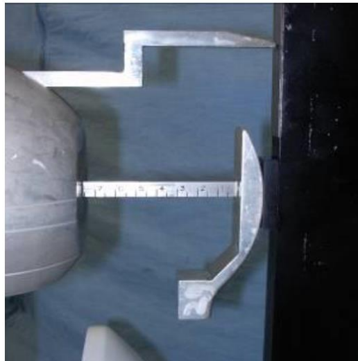
圖 21：HRMD 頭枕間隙及高度校正
