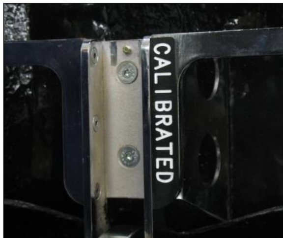
圖 23：校正用軀幹角度量測墊塊與軀幹配重支架連接
