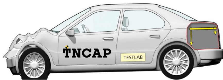
圖 2：試驗後重設座標軸參考框架
