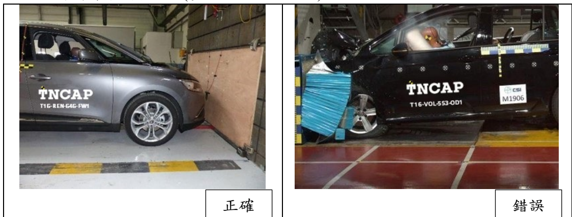
圖 2：字體、試驗參照編號間距及材質圖示範例
