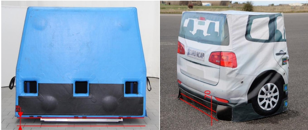
圖 17：目標車前視圖，標示距地面之距離
