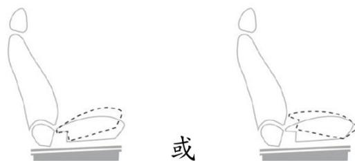
座墊傾斜度(Seat cushion tilt)－在椅背不動之情況下，移動調整座墊將顯著地改變座墊相對於地面之角度（完全向下位置）。此調整可透過移動座墊前方或座墊後方以改變角度。
