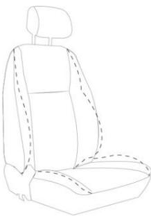
側邊支撐(Side bolsters)－移動調整椅背或座墊側邊，改變座椅外形(Contour)。
