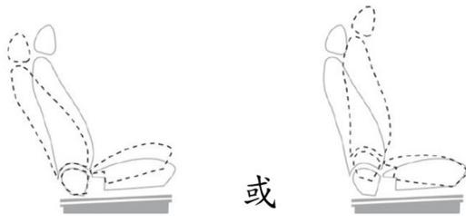
座椅傾斜度(Seat tilt)－轉動調整整張座椅（座墊及椅背同時）。此座椅轉動調整方式將顯著地改變座墊相對於地面之角度(完全向下位置)。此調整可透過向前或向後轉動座椅以改變角度。
